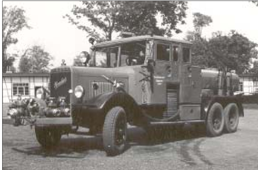
Fliegertankspritze Ts 2,5 der BF Hannover. Das Fahrzeug ist Feuerrot mit schwarzen Kotflügeln und wurde bereits als TLF 25-1 bezeichnet. Schlauchhaspeln beidseitig offen. Das Komet-Schaumrohr wurde gegen ein C-Strahlrohr ausgetauscht. Als Warnrichtung dienen zwei blaue Dachblinkleuchten. Das obligatorische Dachdreieck ist abgeklappt. Gut erkennbar ist das „Mannloch“ auf dem Tankdach.
