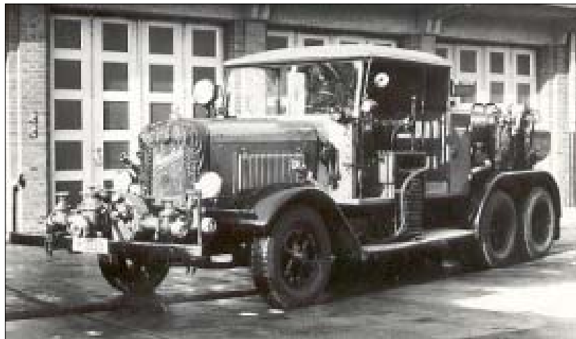
Beim TLF 25-2 der BF Hannover waren die Türen offenbar ausgehängt worden. Auch bei diesem Fahrzeug dürfte es sich um eine Strassenversion gehandelt haben. Die blauen Blinklampen sind hier unterhalb der Windschutzscheibe angeordnet. Ferner gibt es eine Kompressorfanfare. Das neuere Kfz-Kennzeichen sagt aus, dass das Fahrzeug nach Mitte 1956 noch im Dienst gewesen sein muß. Beide Fotos stammen aus dem Archiv der BF Hannover. Sammlung Merlau
