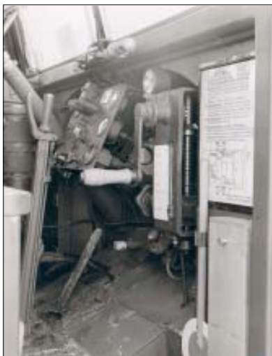
Alle Fotos sind Werkaufnahmen aus dem Archiv Iveco-Magirus. Diese Aufnahmen bildeten einen Teil der Vorbildunterlagen, die der Firma Roco zur Modellkonstruktion zur Verfügung standen. Aufnahme links: Das Kurbelschaltgetriebe, mit dem die Pumpe eingeschaltet wurde.
